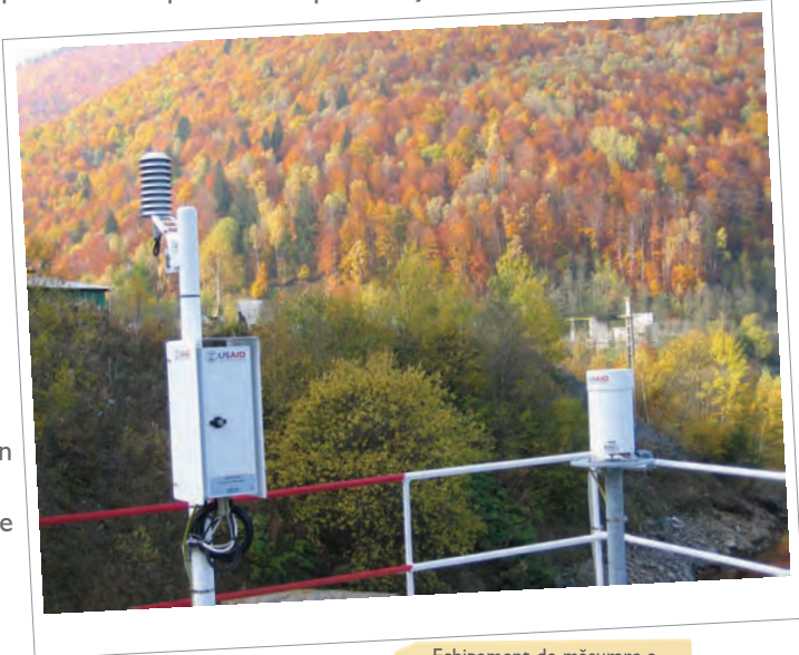
Echipament de măsurare a parametrilor meteo pentru monitorizarea inundațiilor
