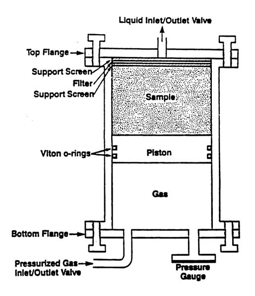
Figure 2. Zero-Headspace Extractor (ZHE)
