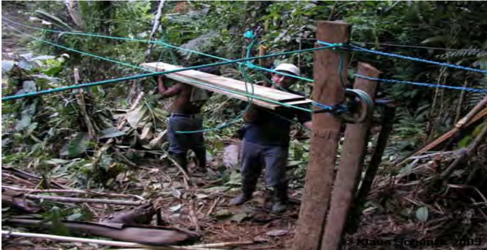
Transporte de madera con cable aéreo por el equipo forestal de la FCAE
