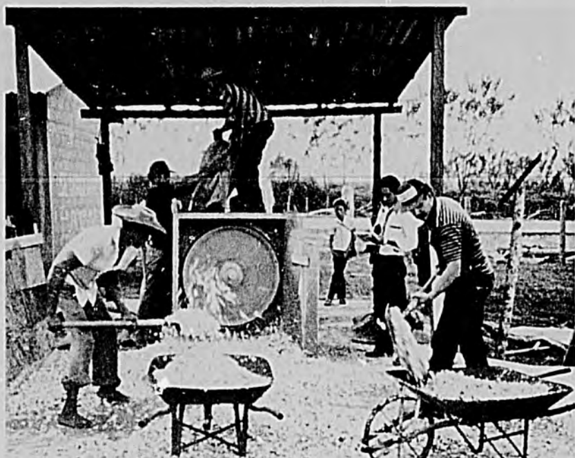
Con las picadoras de yuca y pisos de cemento para el secado, se puede producir yuca seca a bajo costo. (FUENTE: CIAT.)
