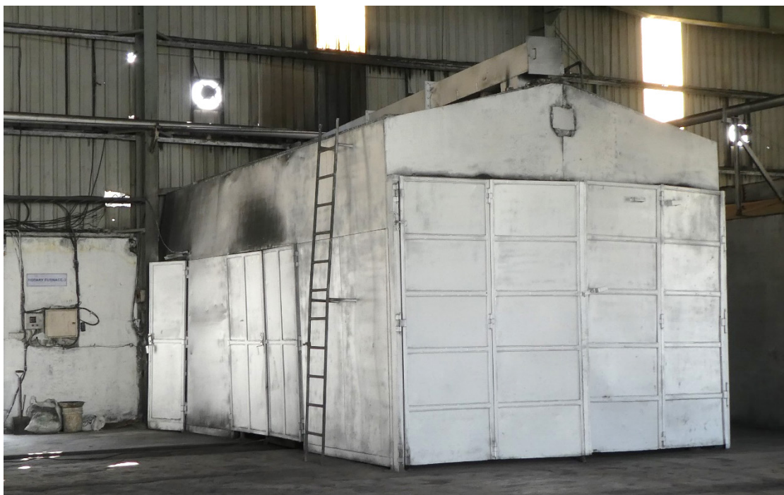
Horno de rotario encapsulado (Cortesía de Gravita India)
