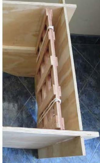
14. **Equipo para el secado de especímenes: Cajón secador.** A, vista de arriba; se aprecian las pestañas interiores donde se calzan las prensas botánicas. B, vista lateral; se observa la abertura en la parte inferior, por la cual ingresa aire fresco. C. Vista de una prensa botánica calzada en la correspondiente pestaña interior del secador.
