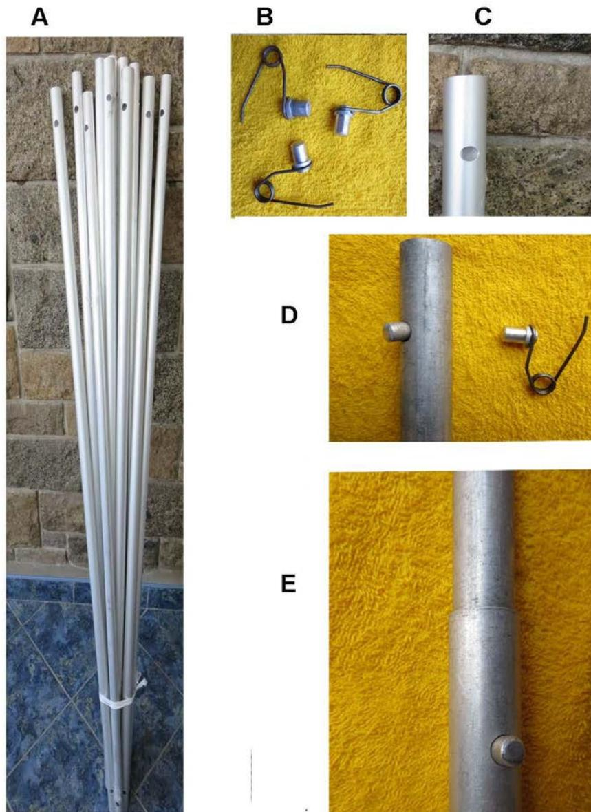
1. **Equipo de colección de especímenes Dendrológicos.** A. tubos de aluminio para Tijera de Podar con Caña Telescópica; B-E, botones con resorte para ensamble de los tubos.
