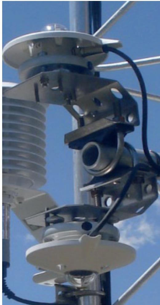
FIGURA 33. PIRANÓMETRO COLOCADOS COMO ALBEDÓMETROS. FIGUEROA (2011).
