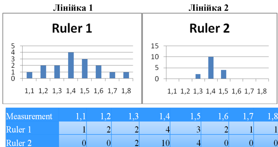
Малюнок 20. Вимірювання двома різними лінійками
