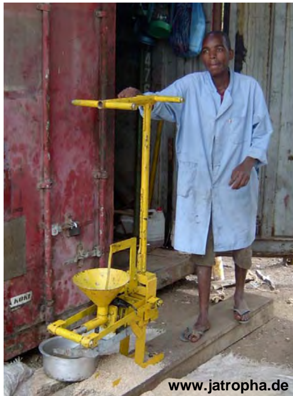
Figure 2. Presse pour production à petite échelle
