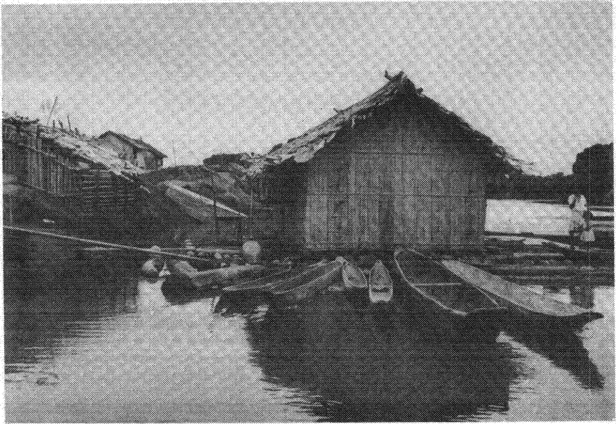
Figura 14. Esta casa flotante de bambú, sostenida por maderos de balsa, se encuentra anclada en un río de Ecuador. Las paredes se hicieron con tablas de bambú; el techo es de hojas entretejidas y se mantiene en su sitio por medio de una serie de caballetes de bambú, colocados a través del techo.
